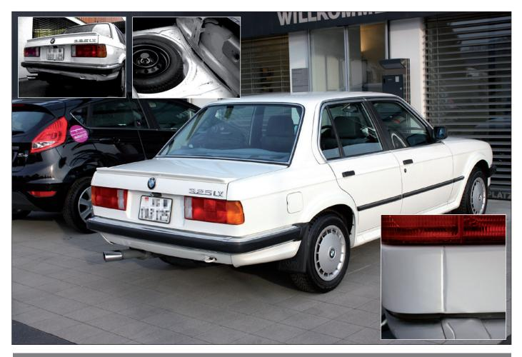
Die beiden Bilder oben links zeigen das beschädigte Auto im Jahr 1999. Auf dem grossen Bild sehen wir das Fahrzeug bei uns im März 2009: Der Zustand ist nach wie vor sehr gut. Und wir durften stolz feststellen, dass die Instandstellung auch nach zehn Jahren nicht sichtbar ist. Die Schweissnähte sind perfekt und ohne jegliche Anzeichen von Korrosion (kleines Bild).
